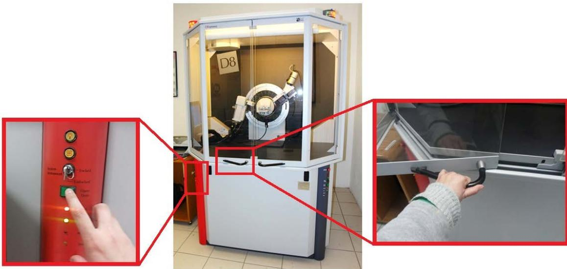
**Figura 26. Presionar el botón “Open door” permite liberar los seguros de las puertas del difractor para colocar o retirar muestra.**
