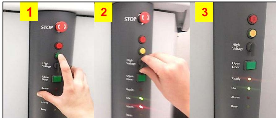
**Figura 14. Secuencia de encendido del difractor: (1) Botón de encendido, (2) girar a la izquierda la llave del alto voltaje, (3) regresar a su posición original la llave de alto voltaje.**
