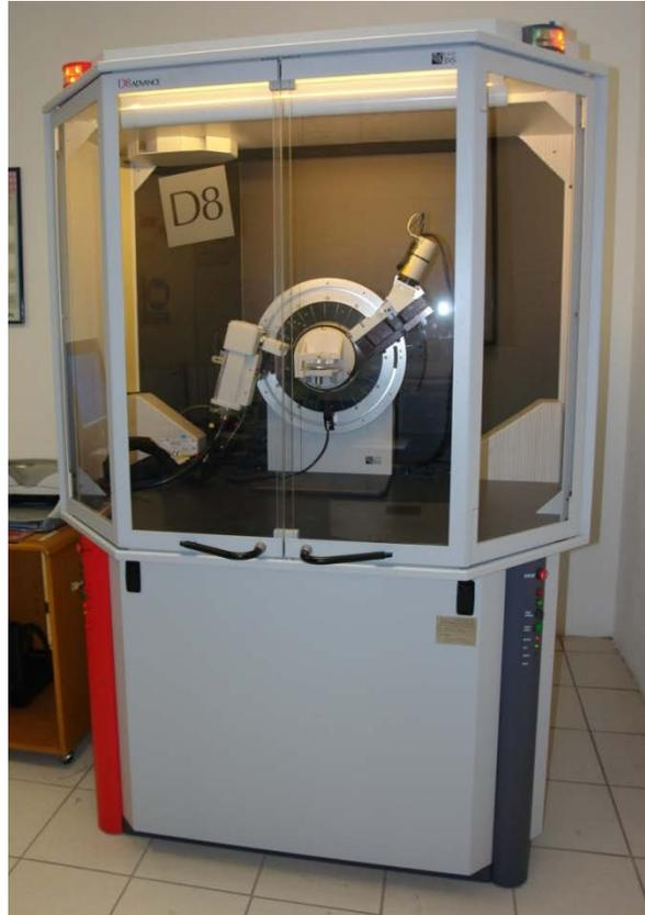
**Figura 6. Difractómetro de polvos de rayos X, modelo D8 ADVANCE de la marca BRUKER AXS.**
