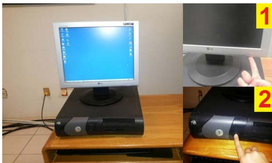
Figura 12. Equipo de cómputo que controla el difractómetro, procedimiento de encendido: (1) encender monitor, (2) encender CPU.
