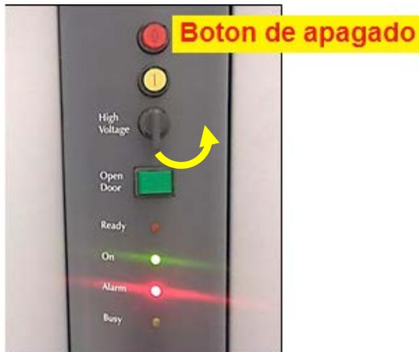
**Figura 34. Tablero de control derecho, boton de apagado y llave de alto voltaje.**
