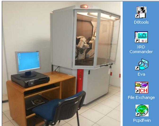
**Figura 10. Equipo de cómputo y software instalado para el control del Difractómetro de rayos X.**
